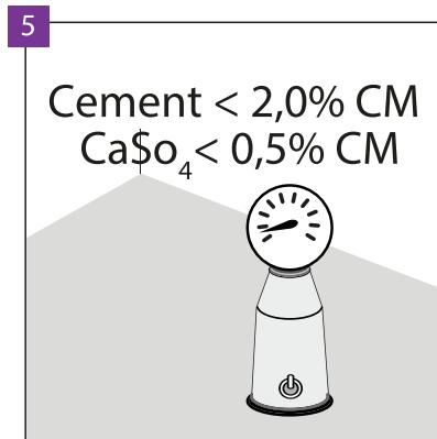
In cazul sapei din ciment, nivelul de umiditate în sapa trebuie să fie mai mic de 2,0%, iar în cazul în care este o sapa anhidrit, umiditatea trebuie să fie sub 0,5%. Dacă efectuați montajul cu sistem de încălzire în pardoseala, valorile mai sus menționate trebuie să fie 1,5% respectiv 0,3%.
