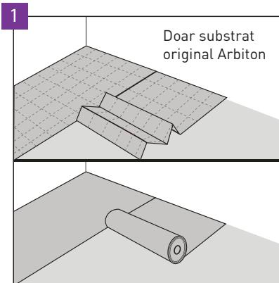
Asezati substratul Arbiton Multiprotec LVT sau Secura LVT click N pozitionat perpendicular pe directia in care vor fi asezate placile. Fasiile alaturate de substrat trebuie asezate strans una langa cealalta si unite cu ajutorul Arbiton Alu Tape fara a lasa spatiu inutile.
