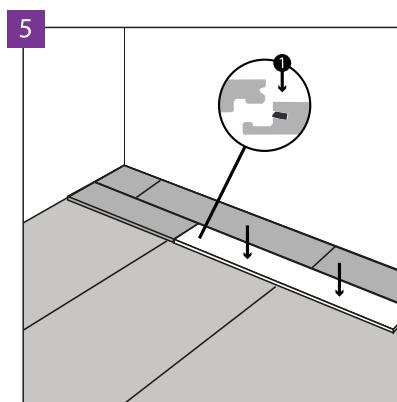
Apoi lasati placa in jos astfel incat sa se inchida/prinda in elementul clic de pe latura scurta, presand usor placa cu degetele, incepand din colt spre corpul dvs. Inchiderea clic de pe latime a placii este prevazuta cu un element special de prindere care clipseaza daca este montata corespunzator. **ATENTIE!** Nu folositi forta in exces! Daca exista dificultati in asamblarea placii si fixarea in clic, mariti usor spatiul dintre placi si coborati din nou placa pentru fixare.
