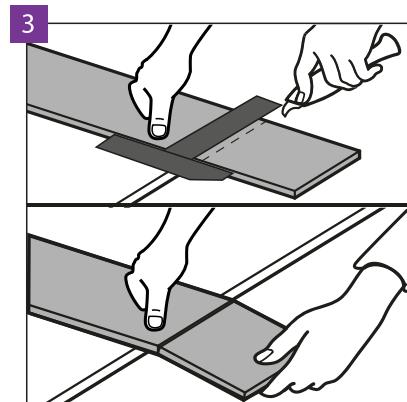
Pentru a taia placa de pardoseala aveti nevoie de un cutit/cutter ascutit; taiati suprafata superioara apoi asezati placa pe o margine pentru a o rupe cu o miscare rapida. Placile de pardoseala pot fi deasemenea taiate utilizand un ferastrau electric.
