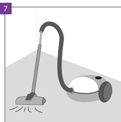
Asigurati-vă ca sapa este uscată, plană, stabila și nu are grăsimi sau substanțe chimice. Denivelările proeminente trebuie razuite pentru a fi eliminate. Înainte de instalare suportul trebuie maturat și aspirat cu atenție pentru a îndepărta orice murdarie. Este necesar să reparati/corectați orice imperfecțiuni/denivelări majore ale sapei și crapaturile mari.
